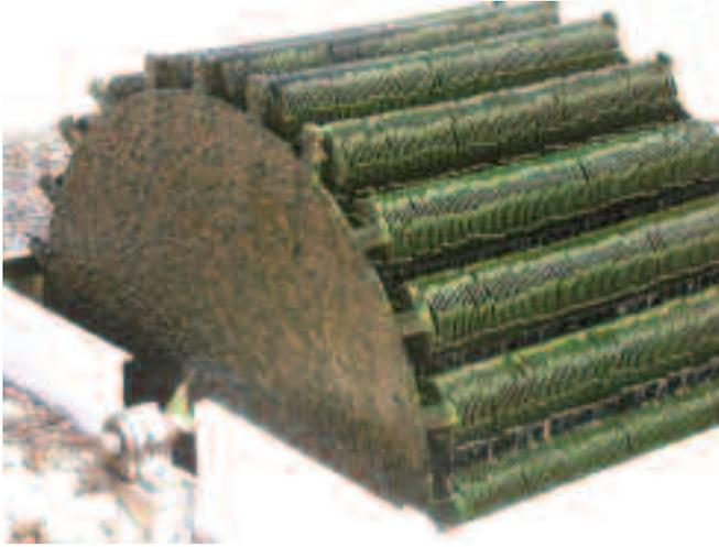
Photo 5.20. Détail de Contacteur Biologique Rotatif.
