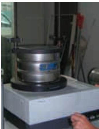
Sistema de tamización automática utilizado en los laboratorios para el estudio granulométrico de los suelos
