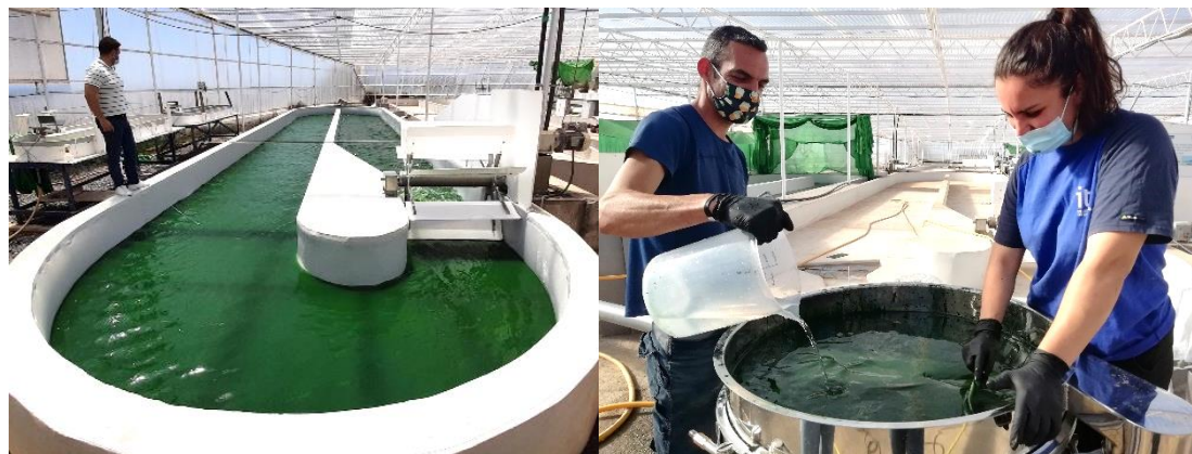
Figura 6. Imágenes del equipamiento en la sede del Instituto Tecnológico de Canarias en Pozo Izquierdo (Santa Lucía de Tirajana, Gran Canaria, España). De izquierda a derecha: raceway de 80 m 2 bajo invernadero de 1500 m 2 ; tamizadora vibratoria empleada en la separación de la biomasa de microalgas desde el medio de cultivo.
