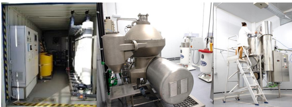
Figura 5. Imágenes del equipamiento en la sede del Instituto Tecnológico de Canarias en Pozo Izquierdo (Santa Lucía de Tirajana, Gran Canaria, España). De izquierda a derecha: sistema de microfiltración contenerizado para aguas de insumo; centrifugas para la separación sólido-líquido de la biomasa de microalgas desde el medio de cultivo; atomizador giratorio para el secado en forma de polvo de la biomasa húmeda.
