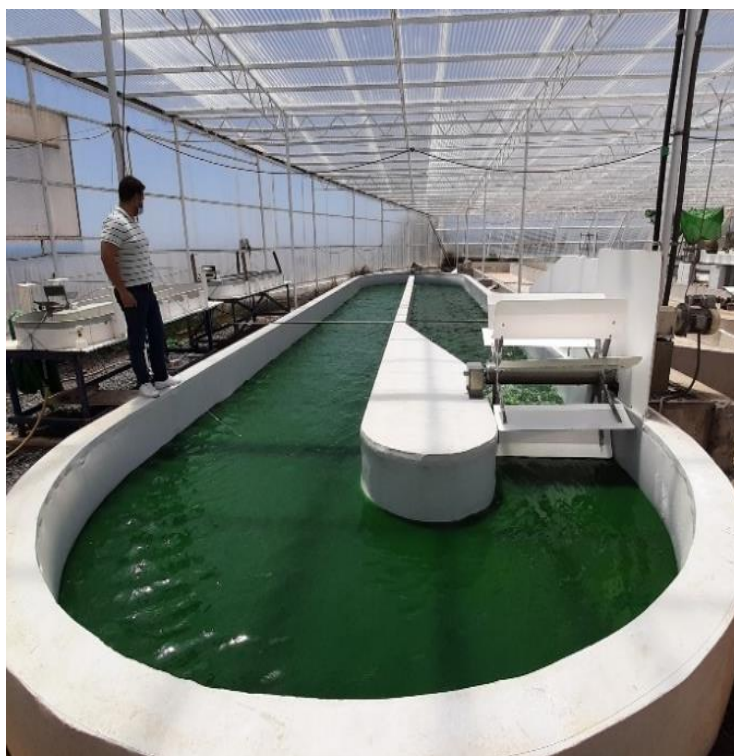
Figura 4. Cultivo de A. platensis BEA 1257B en agua de mar 100%, en raceway de 80 \text{ m}^2 bajo invernadero en las instalaciones del ITC.
