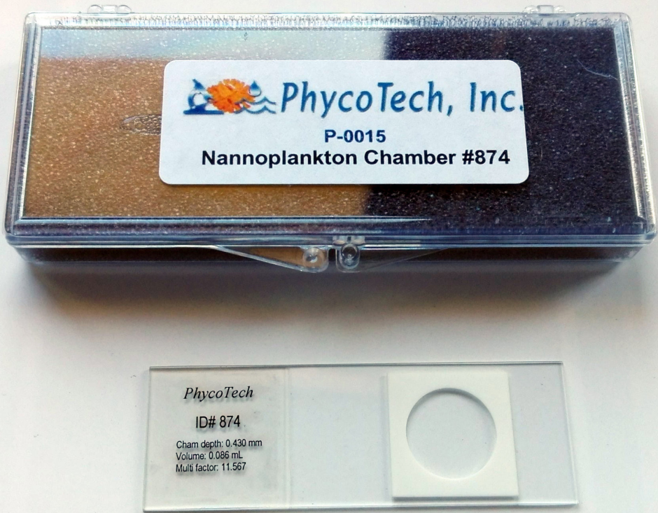
Figura 8. Cámara de Nannoplankton (86 µL) usado para la observación y monitorización de Gambierdiscus y Fukuyoa spp.
