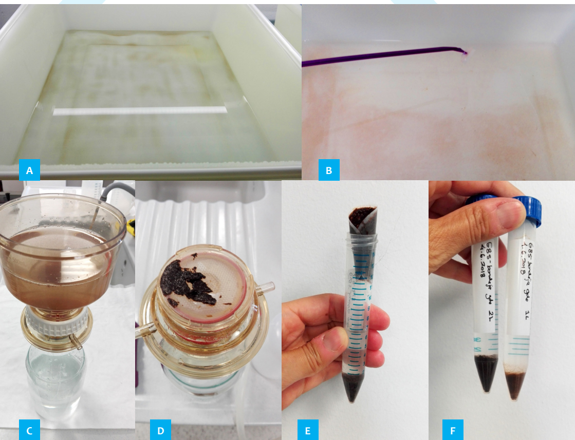
Figure 12. Séquence montrant les étapes de la récolte de cellules de Gambierdiscus / Fukuyoa . (A) Culture d'une souche de Gambierdiscus sp. dans un bac Nalgene™ en polypropylène. (B) Décollement des cellules du fond du bac, à l'aide d'un grattoir de cellules. (C) Filtration sous vide en utilisant un filtre en nylon de 47 mm de diamètre avec une porosité de 20 µm (Millipore™). (D) Concentré de cellules retenues par le filtre. (E) Les cellules sont transférées des filtres dans un tube Falcon® de 15 mL, en utilisant des grattoirs ou du pipetage avec de l'eau de mer stérile. (F) Pellet de cellules dans des tubes Falcon® de 15 mL, résultant de l'élimination du surnageant après centrifugation (3000 rpm, 5 min, 20 °C).
