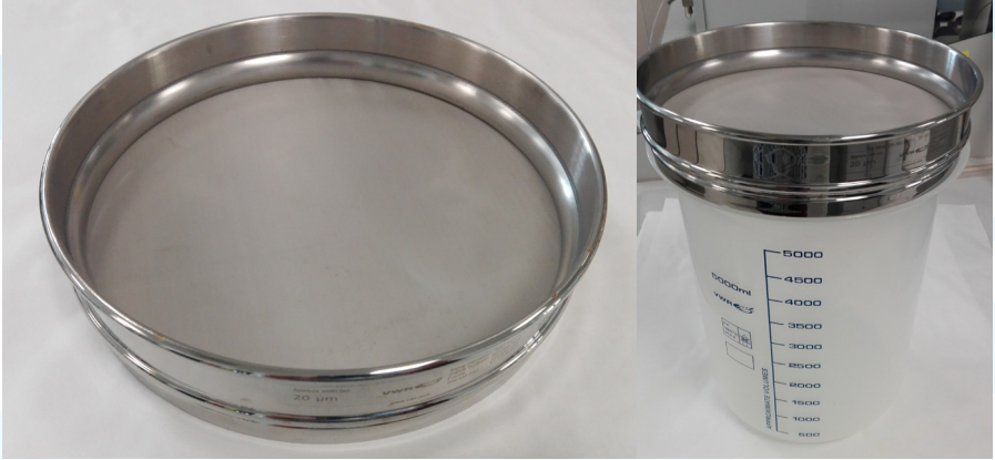
Figura 13. Tamiz de acero inoxidable utilizado para retención de células de Gambierdiscus/Fukuyoa . El tamiz tiene un poro de 20 \mu\text{m} y un diámetro de 20 cm.
