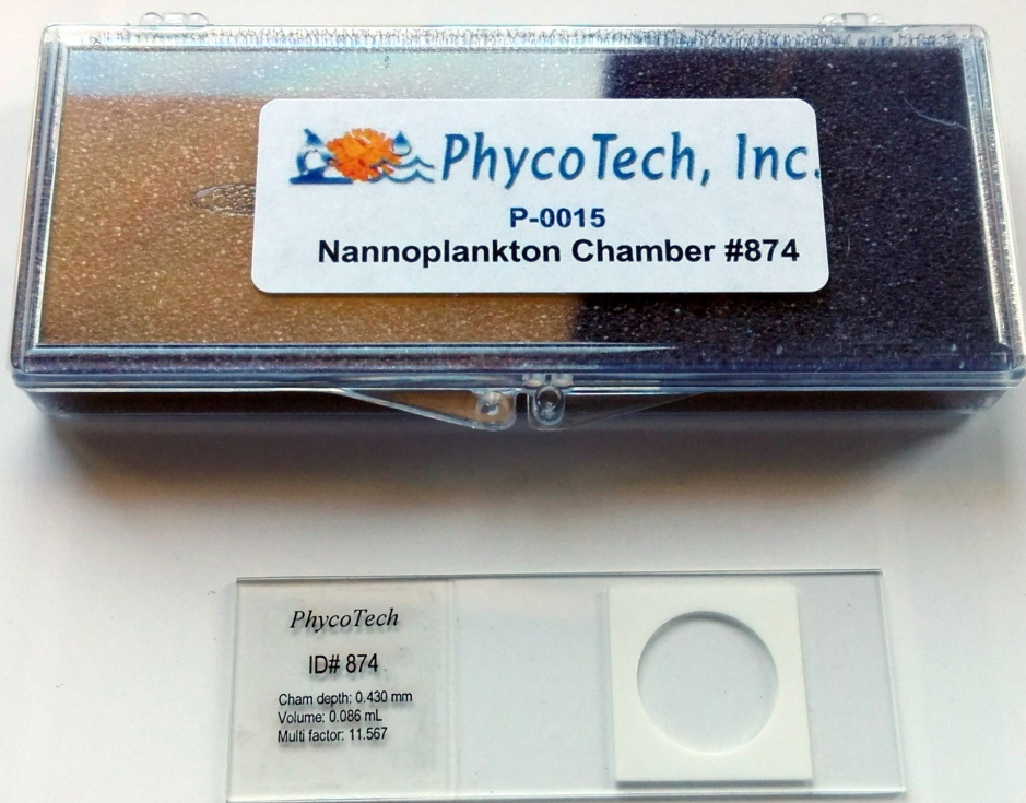
Figura 8. Câmara de Nanoplâncton (86 µL) usado para a observação e monitorização de culturas de Gambierdiscus e Fukuyoa spp.
