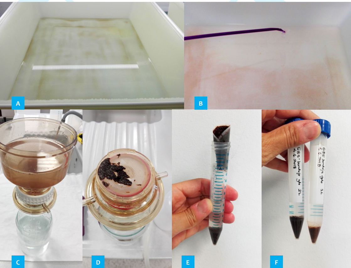
Figura 12. Secuencia de pasos de cosechado de células de Gambierdiscus sp. Cultivo de una cepa de Gambierdiscus sp. en un sistema de bandeja Nalgene (A); Cosechado con raspadores de cultivo celular (B); Filtración por filtro de nylon de diámetro de poro de 20 \mu\text{m} y diámetro de 47 mm de Millipore™ (C); Concentrado de células obtenido por filtración (D); Retirada de las células retenidas en el filtro con la ayuda de raspadores o pipeteo con agua de mar estéril (E); pellets de células obtenidas después de centrifugación (3000 rpm, 5 min, 20 °C) en tubos tipo Falcon® (F).
