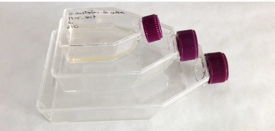
Figura 4. Frascos de cultivo celular e rosca com filtro com diferentes capacidades de volume de cultivo (VWR®). De cima para abaixo, frascos com uma área de superfície de 25, 75 y 182 cm 2 . A superfície máxima destes recipientes disponível no mercado corresponde, aproximadamente, a 300 cm 2 .
