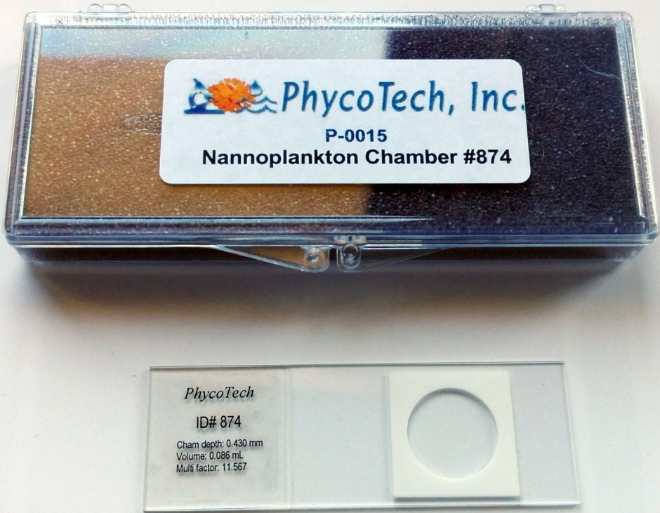
Figure 8. Chambre de Nannoplankton (86 \mu L) utilisée pour l'observation et le suivi des cultures de Gambierdiscus et de Fukuyoa .
