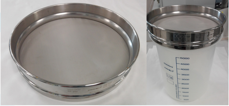
Figure 13. Tamis en acier inoxydable (diamètre : 20 cm) utilisé pour la récolte des cellules de Gambierdiscus / Fukuyoa . Le tamis présente une maille en acier inoxydable avec une porosité de 20 µm.
